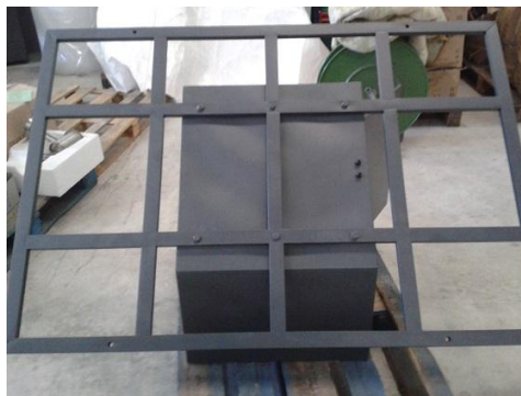
Joignez le support du panneau (4) à la caisse des batteries (3)
